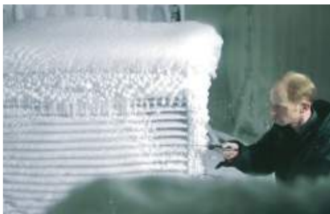
Testne skupine upravljajo z enotami v ekstremnih podnebnih razmerah v podnebni komori
